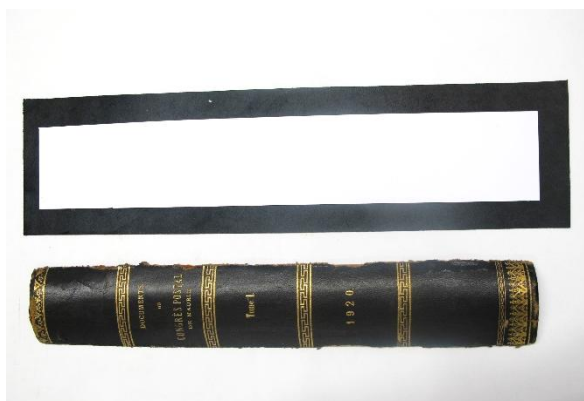
Nouveau dos en cuir noir avant et après collage sur le dos du livre
