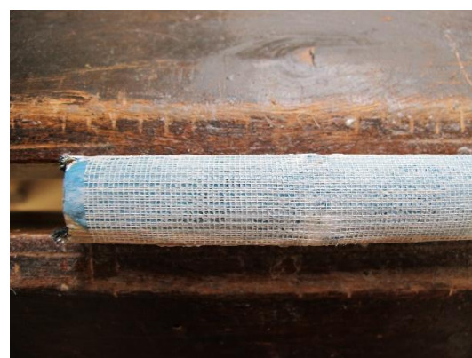
Collage du dos et pose d'une mousseline
